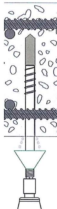
Würth Verbundankerschraube RELAST für die Querkraftverstärkung
